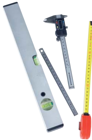
Ein wichtiges Detail für den Heimwerker sind die im Set enthaltenen Messwerkzeuge. Mit digitaler Schieblehre, kleinem Stahlmaß, 3 Meter Bandmaß und einer Wasserwaage ist dieser Werkzeugkoffer mehr als umfangreich bestückt
